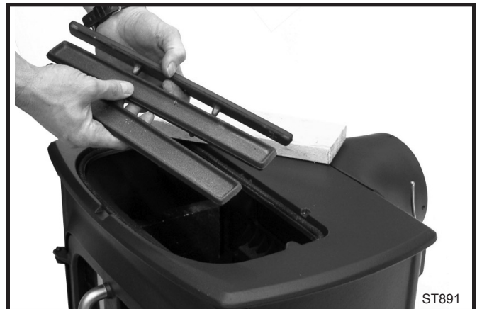
Fig. 13 Remove burn grates.
