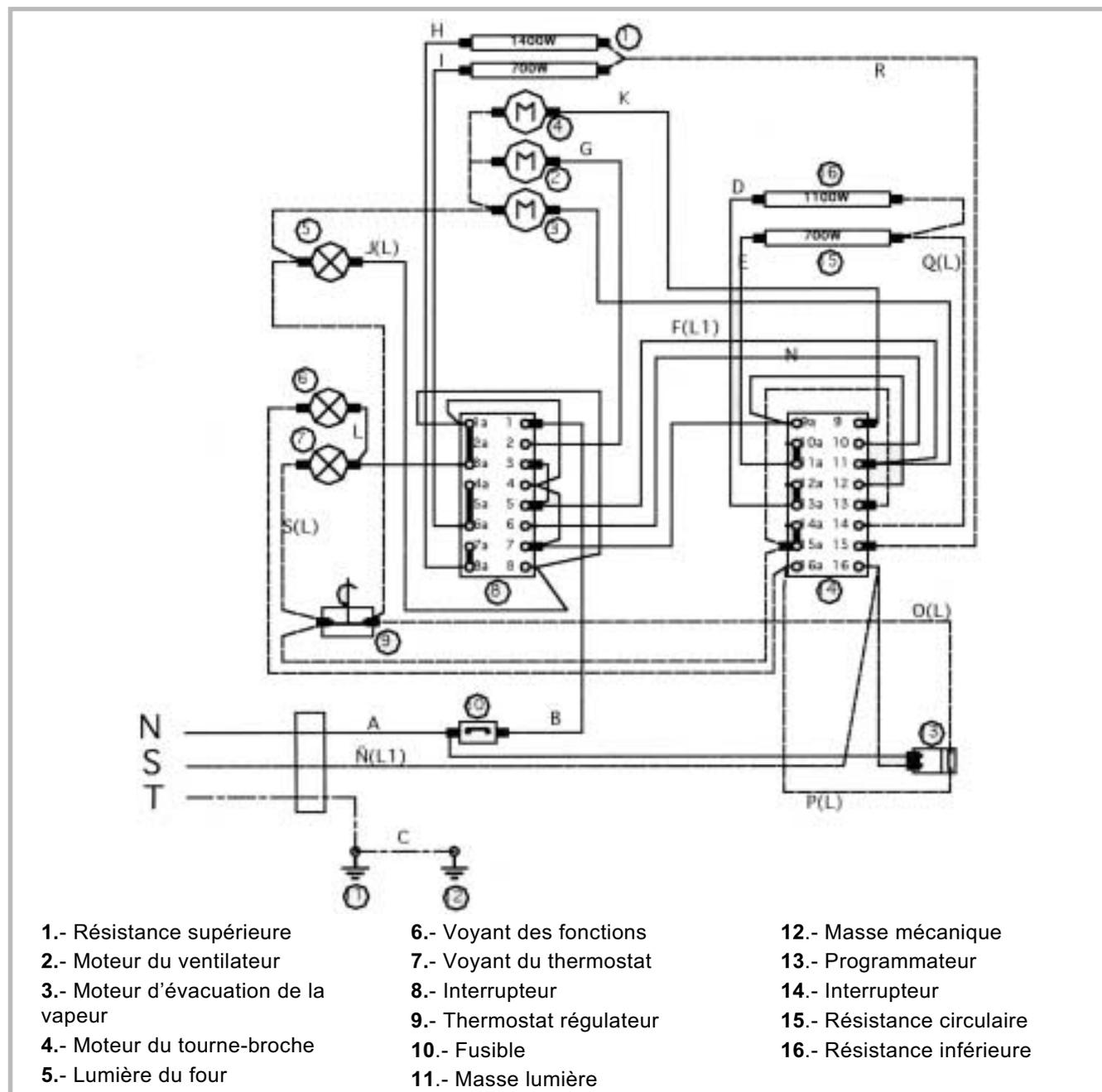
Figure 10 - Schéma électrique
