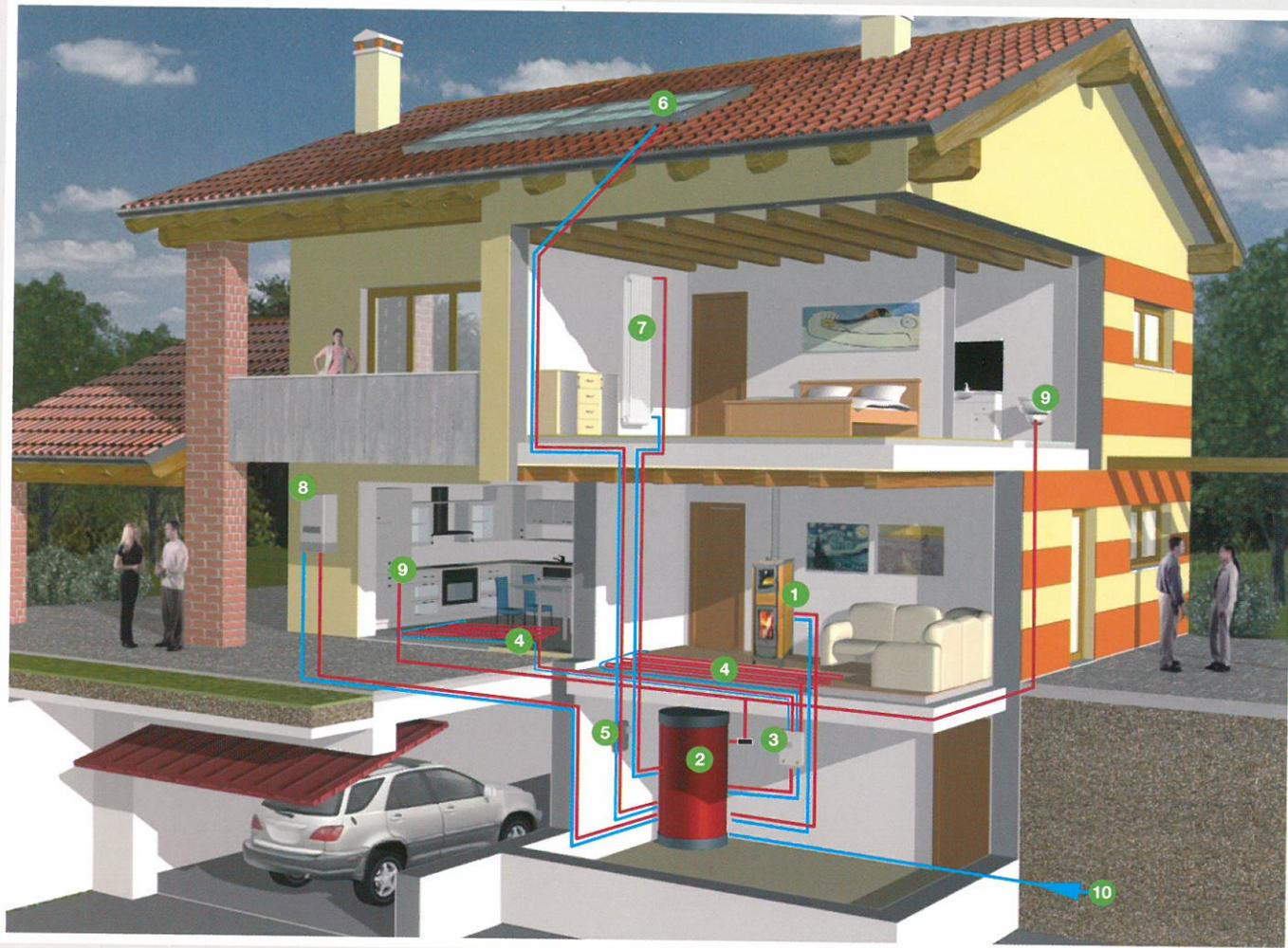
**Esempio indicativo di generatore di calore a legna abbinato a pannelli solari**
